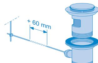
la tige de commande de clapet de bonde doit être prolongée de 60 mm (par exemple au moyen de l'accessoire GROHE réf. 95911).
