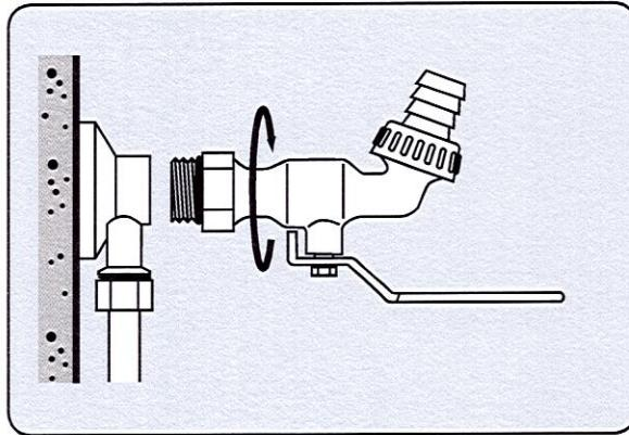
2 - Visser le robinet sur l'applique sans filasse ni téflon. La présence du joint torique assure l'étanchéité.
