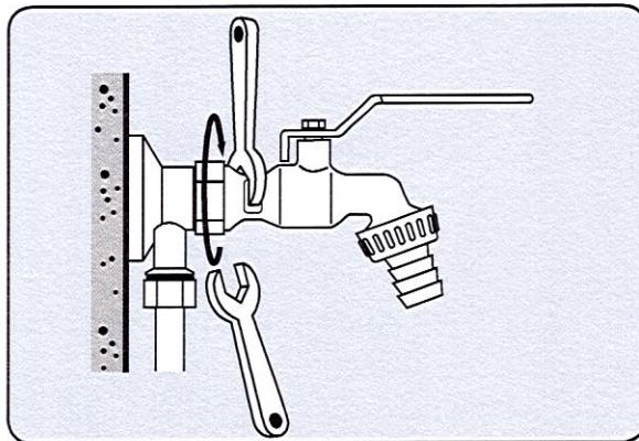
4 - Verrouiller la position en serrant le contre-écrou à l'aide d'une deuxième clé.
