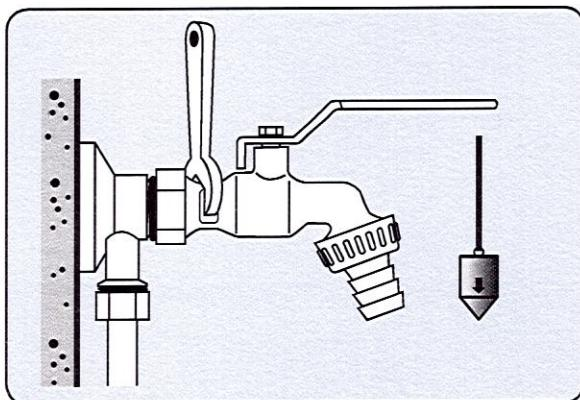
3 - Orienter le robinet dans la position souhaitée. Maintenir le robinet en place à l'aide d'une clé, et grâce aux méplats.
